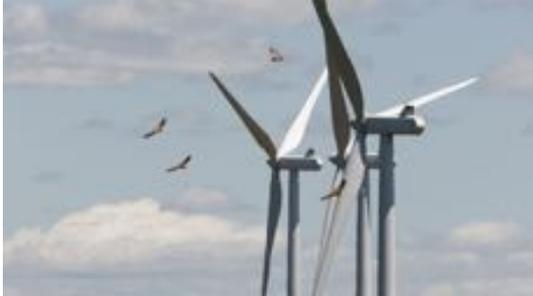
Dans le cas de l'éolienne la production est dépendante de la force du vent. Elle peut produire quand la vitesse du vent est de 15 à 90 km/h. Elle utilise un alternateur pour produire directement un courant alternatif. Plusieurs technologies existent pour assurer une production à 50 Hz, mais il faut garder à l'esprit que l'opérateur de l'éolienne ne peut pas anticiper (quelle sera la vitesse du vent dans 28 minutes ou dans 7
